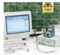
パルス変調蛍光測定は、周囲光の下で、暗順応あるいは明順応されたサンプルを測定できます。FMSは、ファイバーケーブルを使用するので、液相・ガス相の酸素モニターと蛍光測定が同時にできます。
