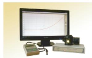
液状サンプルからの呼吸と光合成を測定するシステムです。LEDの照射時間や照射時間をプログラムでき同じ条件で測定が出来ます。温度センサーからの温度表示が同時に出来ます。
