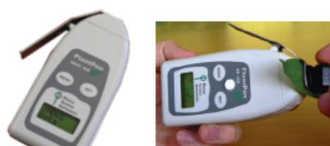
フルオロペンは野外で簡単にクロロフィル蛍光が測定できる、携帯型の機器です。操作性に優れた2つのボタンを使い測定を行い、測定した、Fo、Ft、Fm、Fm'、QY等は、内部メモリに保存され、USBケーブル経由で、データをPCへ転送できます。
