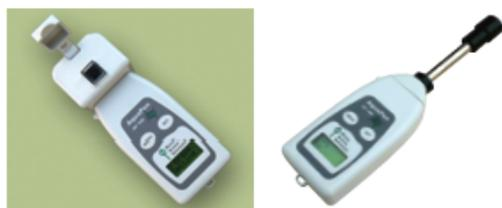
アクアベンCは4mlのキューベットを搭載したクロロフィル蛍光測定器です。アクアベンPは防水型プローブを備え、水中に直接差し込み、測定ができるクロロフィル蛍光測定器です。両機種ともに、0.5 μg Chl/lの高い感度で動作します。操作性に優れた2つのボタンを使い測定を行い、測定値は自動保存されます。
