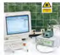
パルス変調蛍光測定は、周囲光の下で、飽和応あるいは明順応されたサンプルを測定できます。FMSは、ファイバーケーブルを使用するので、液相・ガス相の酸素モニターと蛍光測定が同時にできます。
