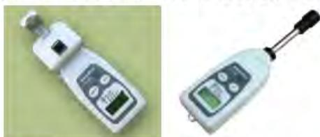
アクアペンCは4mlのキューベットを搭載したクロロフィル蛍光測定器です。アクアペンPは防水型プローブを備え、水中に直接差し込み、測定ができるクロロフィル蛍光測定器です。両機種ともに、0.5µg Chl/lの高い感度で動作します。操作性に優れた2つのボタンを使い測定を行い、測定値は自動保存されます。
