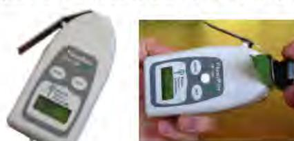
フルオロペンは野外で簡単にクロロフィル蛍光が測定できる、携帯型の機器です。操作性に優れた2つのボタンを使い測定を行い、測定した、Fo、Ft、Fm、Fm'、QY等は、内部メモリに保存され、USBケーブル経由で、データをPCへ転送できます。
