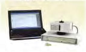
温度制御機能により、チャンバー内の温度を+3~40°Cの範囲で、±0.5の精度でコントロールできます。光源、蛍光測定用のプローブが接続できるように、ポートが1つ付いています。
