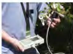
携帯型野外蛍光測定器で、単独使用可能なクロロフィル蛍光器です。葉をリーフクリップで暗処理後、発光ヘッド/検知器ユニットを取り付け測定し、多数の測定が迅速に行えます。
